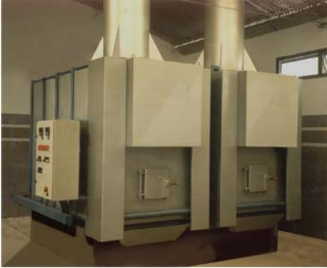
*Permite el montaje simétrico, en espejo, reduciendo al mínimo el área ocupada en planta.*
