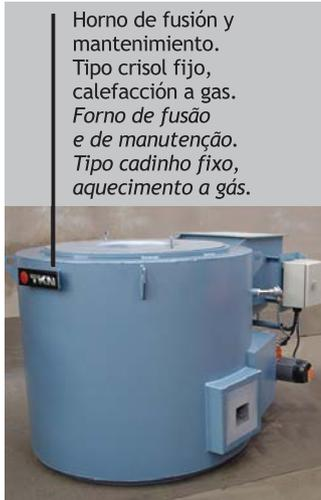
Horno de fusión y mantenimiento.
