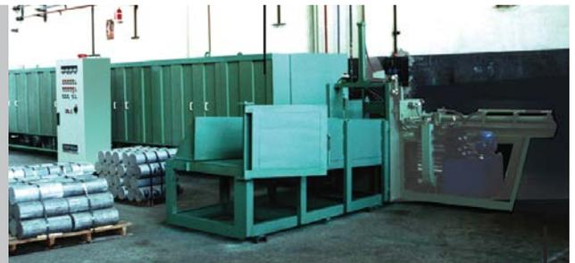
Horno de calentamiento para extrusión de billets de aluminio. Avance por empuje.
