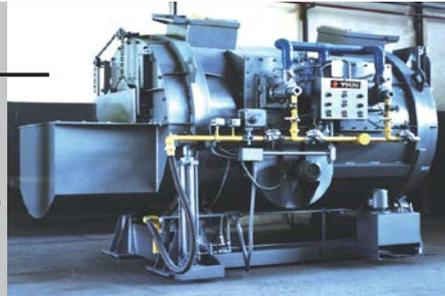
Horno para fusión. Tipo reverbero volcador en piqueta.
