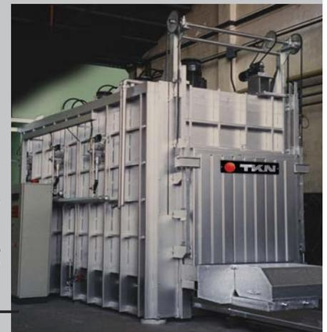
Horno de solera móvil para homogeneizado.
