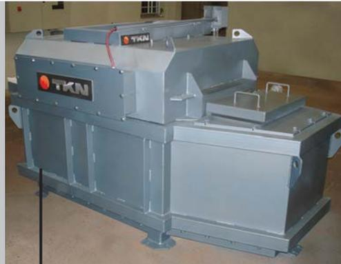
Horno de mantenimiento. Tipo sin crisol.
