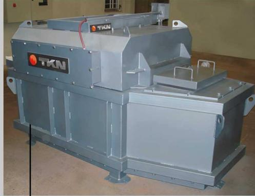
**Horno de mantenimiento. Tipo sin crisol.**
