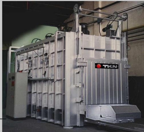
**Horno de solera móvil para homogeneizado.**
