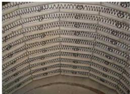
**Detalle de las resistencias. Montadas sobre sólidas piezas cerámicas de diseño especial.**
