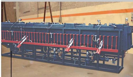
**Horno de calentamiento para extrusión de billets de aluminio. Avance por empuje.**
