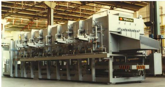
**Horno de calentamiento para extrusión de billets de aluminio. Avance por paso peregrino.**
