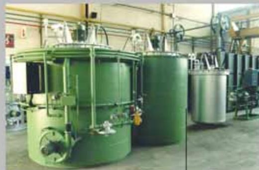
Instalación de pote para recocido bajo atmósfera
