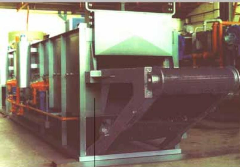
Instalación continua para secado de pintura de envases serigrafiados
