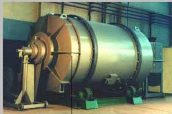
Horno para fusión a crisol volcador en piquera
