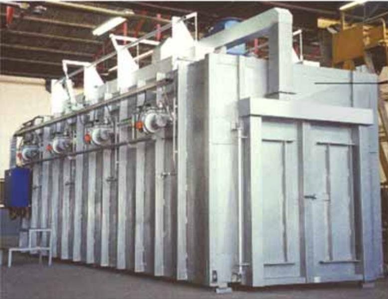
Estufa para secado de ladrillos prensados carga en vagoneta
