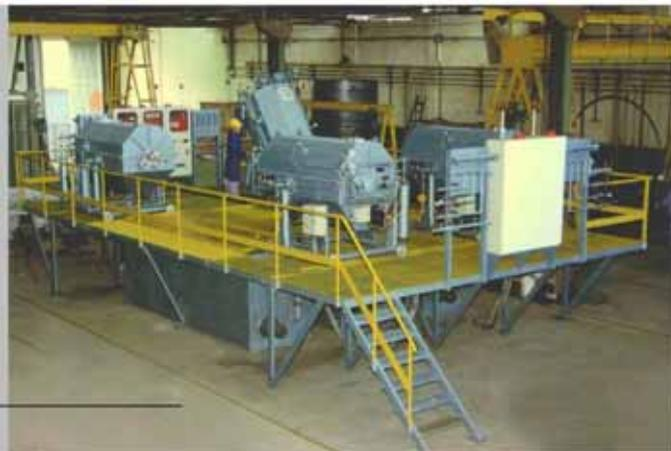
Instalación para carbonitruración y temple rotativo y basculante
