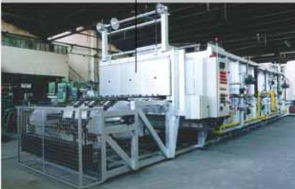
Instalación continua para secado
